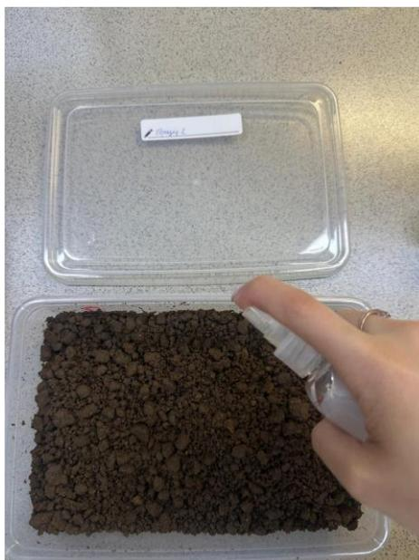
Рисунок 11 – Дождевание образца под номером 2
