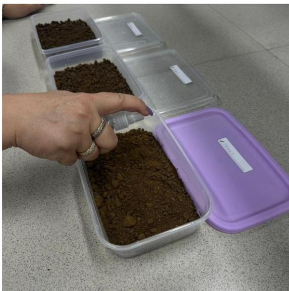
Рисунок 7 – Смачивание образцов биопрепаратом Bio-Solv D-Medium
